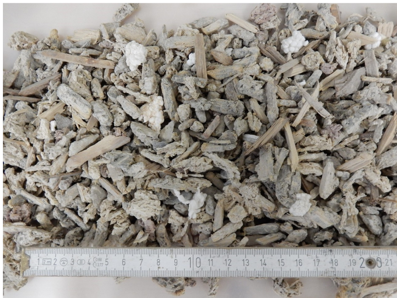
Abbildung 21: Leichtstoffe 10- 20 mm aus Zick- Zack- Sichter
