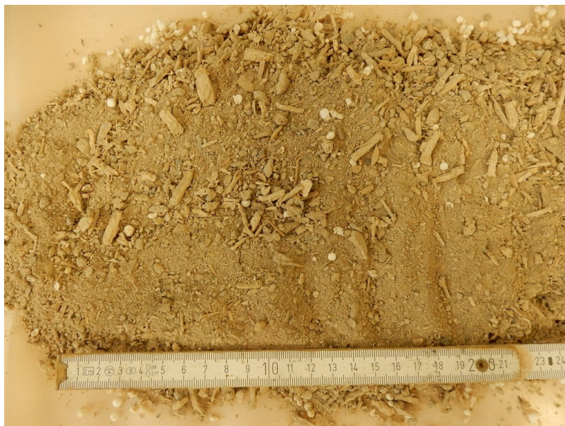
Abbildung 19: Leichtstoffe 0- 10 mm aus Zick- Zack- Sichter
