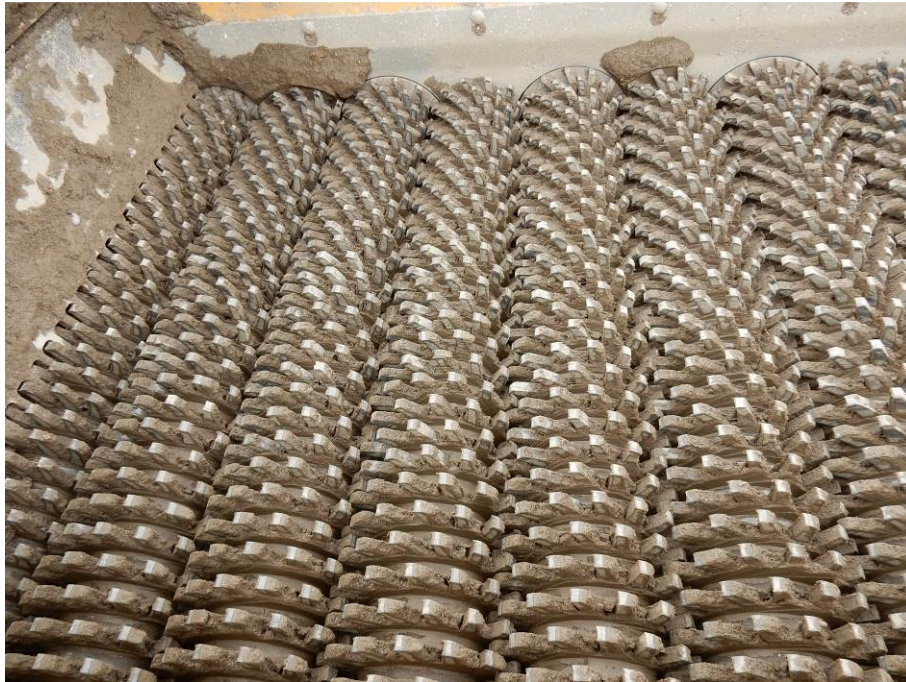
Abbildung 11: Siebrollen eines Sternsiebs
