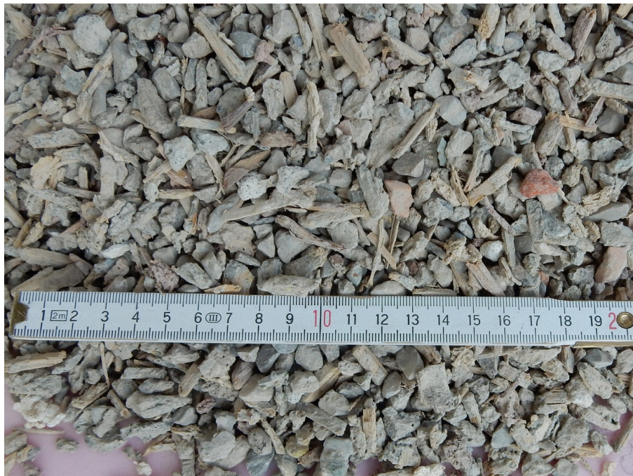
Abbildung 14: Leichtstoffe 3- 12 mm aus Windsichter
