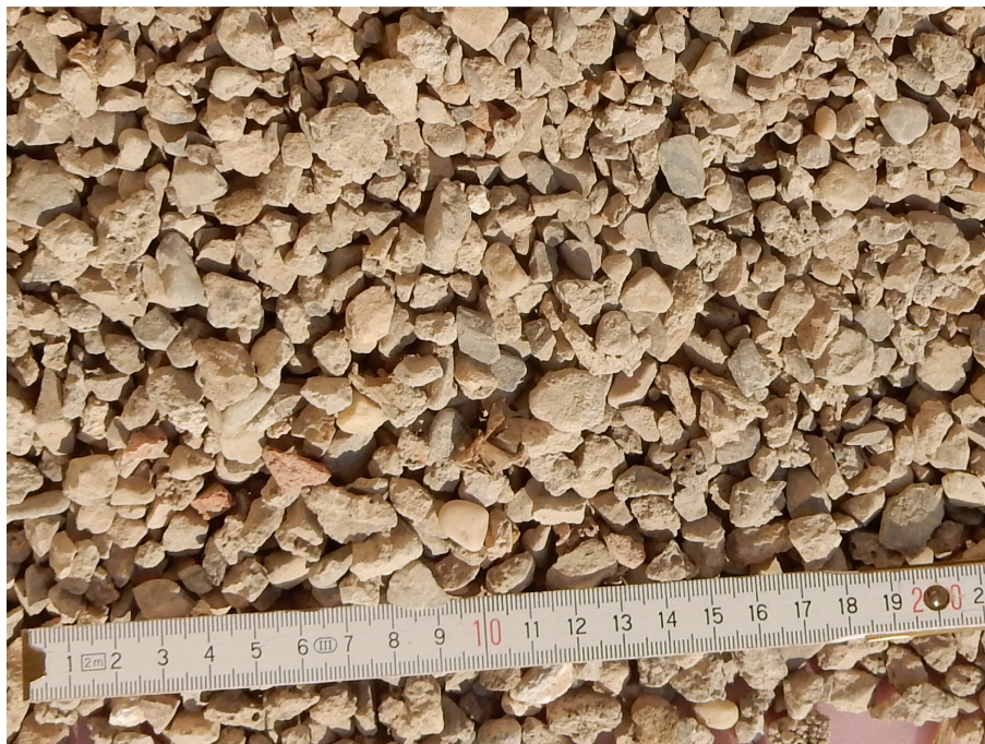
Abbildung 15: Schwerstoffe 3-12 mm aus Windsichter
