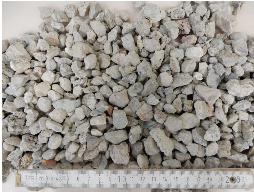
Abbildung 20: Schwerstoffe 10- 20 mm aus Zick- Zack- Sichter
