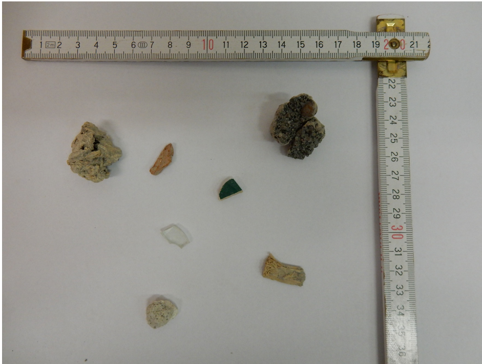
Abbildung 16: Auswahl an Fremdstoffen in Schwerstoffen aus dem Windsichter
