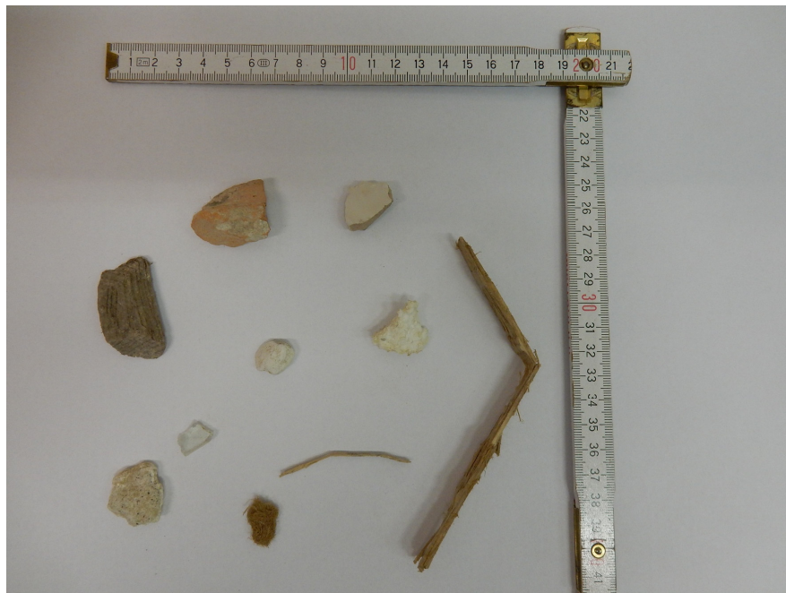
Abbildung 17: Fremdstoffe in der Leichtstofffraktion aus dem Windsichter
